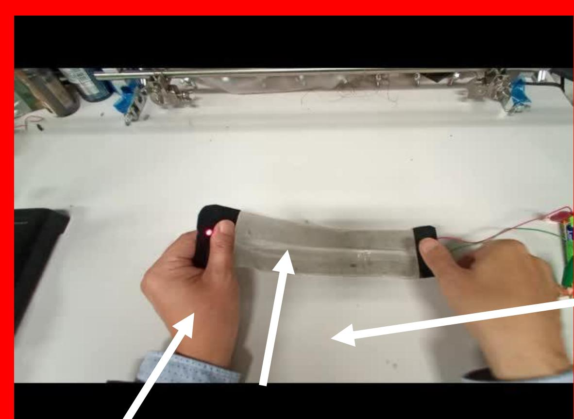
赤色 LED 配線を伸ばしてもLEDの輝度が変わらない。→電気抵抗が安定
